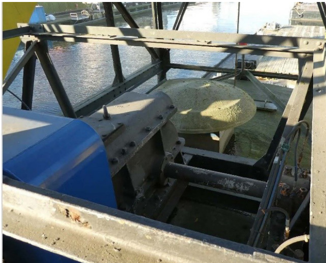
Met de klok mee: kraandrijvers stoel, gemoderniseerd in 1996; Topwerk aandrijving; Zicht vanuit de cabine; Zwenkrail met wielstellen en koningsspil. Foto's: Helmig Kleerebezem
