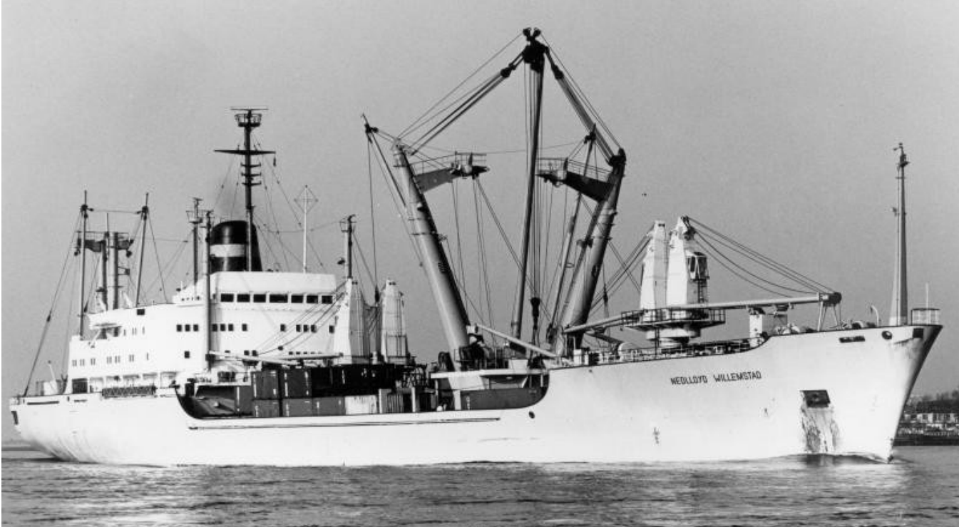
Het ultieme Nederlandse zware lading schip, de Nedlloyd Willemstad, in 1970 als Trident Amsterdam bij de Scheepswerf P. Smit jr. in Rotterdam; voor de KNSM. Het schip heeft traditionele laadbomen, elektrische dekkranen en een Stülcken mast voor een zware spier. Via dit systeem kon een zware spier twee ruimen bedienen. Hij was snel gebruiksklaar. Het schip is gesloopt in 1992. De ontwikkelingen gingen snel. Bron: Marhisdata
