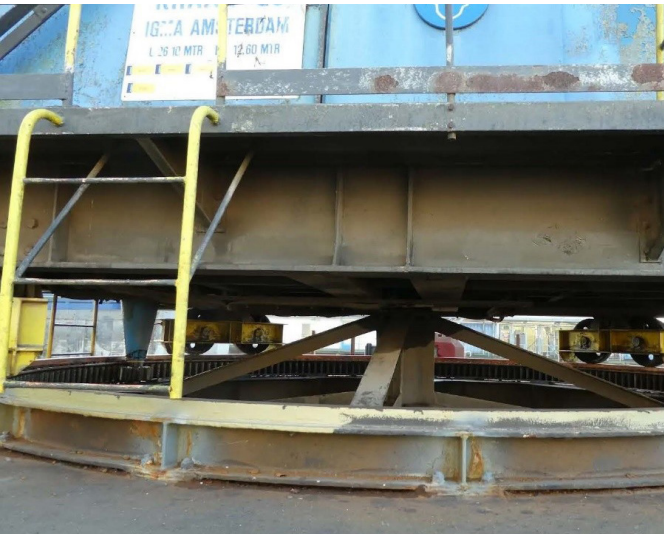
Met de klok mee: kraandrijvers stoel, gemoderniseerd in 1996; Topwerk aandrijving; Zicht vanuit de cabine; Zwenkrail met wielstellen en koningsspil. Foto's: Helmig Kleerebezem
