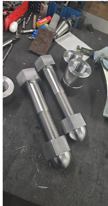
Van links naar rechts: Deksel voor op de draaikrans met gat voor koningsspil, een mooi gietstuk en fraai klinkwerk; Ook voor de toe passen bouten is maatwerk vereist; Noeste werkers bezig met het samenstellen van giekdelen. Foto's boven en links onder: Stichting Herbouw Kadekraan Kampen.
