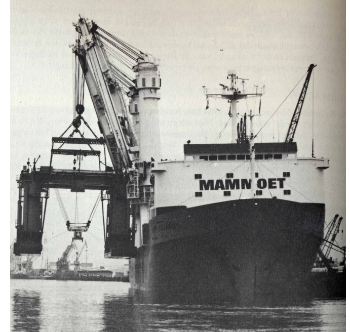
De oudste Huisman Heavy Lift Mast kranen. Zwareladingsschip Happy Buccaneer tijdens een proefhijs in 1984.
