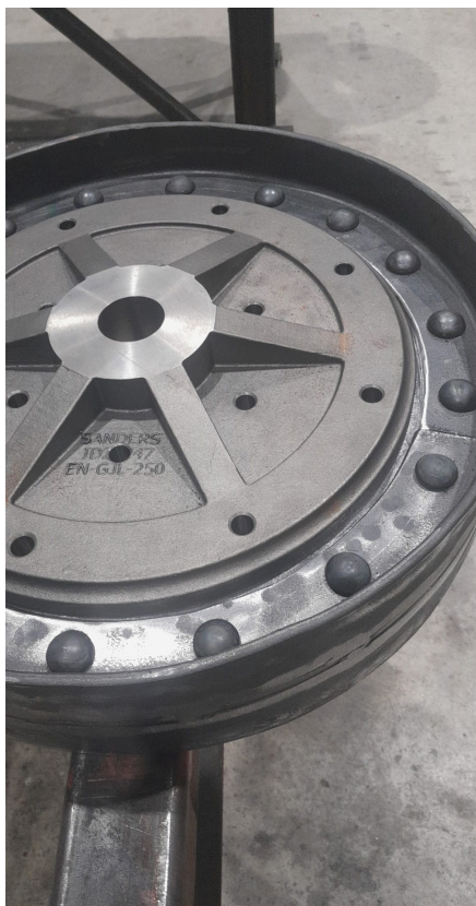
Van links naar rechts: Deksel voor op de draaikrans met gat voor koningsspil, een mooi gietstuk en fraai klinkwerk; Ook voor de toe passen bouten is maatwerk vereist; Noeste werkers bezig met het samenstellen van giekdelen. Foto's boven en links onder: Stichting Herbouw Kadekraan Kampen.
