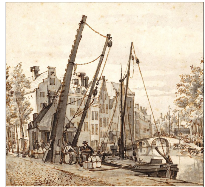
Voordat de derrick kraan in Schotland werd ontwikkeld stonden er in Nederlandse steden al ongeschoorde laadboom kranen aan de grachten. Tekening van Gerrit Lamberts 1817 Binnenschip met laadboom Nieuwezijds Voorburgwal. Stadsarchief Amsterdam.
